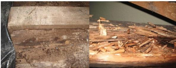
Figura 1. Estructuras dañadas por hongos de pudrición parda o cúbica. Fuente: AIDIMME
