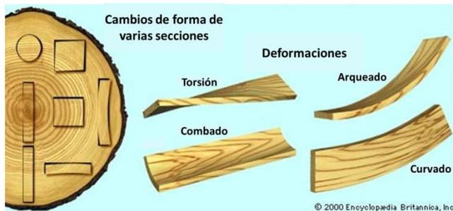
Figura 2. Distorsiones del sustrato debidas a los cambios de humedad.
